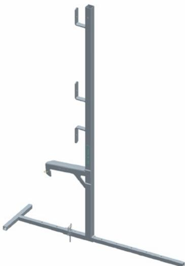
Die Schutzgeländer werden an der Dachkante oder am unteren Dachende befestigt und beinhalten das Sicherheitszubehör (Abschlussleisten, Fußleisten, Netze), um einen vollständigen Schutz zu gewährleisten.
